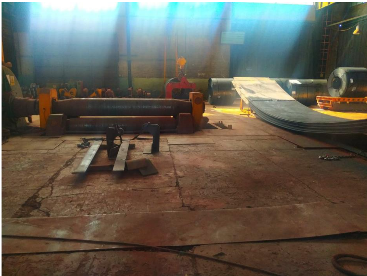
شکل 1: دستگاه نوردهای چهار غلطک (نوردهای ورق تا ضخامت ۱۰۰ میل)
